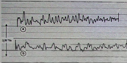
Bild 5 Tönhöhen-schwankungen „über alles“ a) linear, b) bewertet
